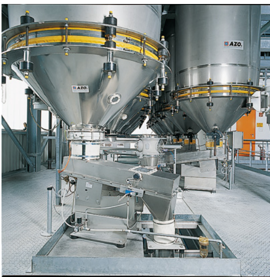
Bild 26: Siloentleerung über eine Vibrationsrinne (links: AZO GmbH & Co. KG)
