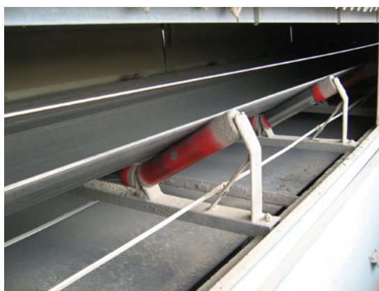
Bild 28: Bandförderer zum Transport großer Produktmengen über weite Strecken
