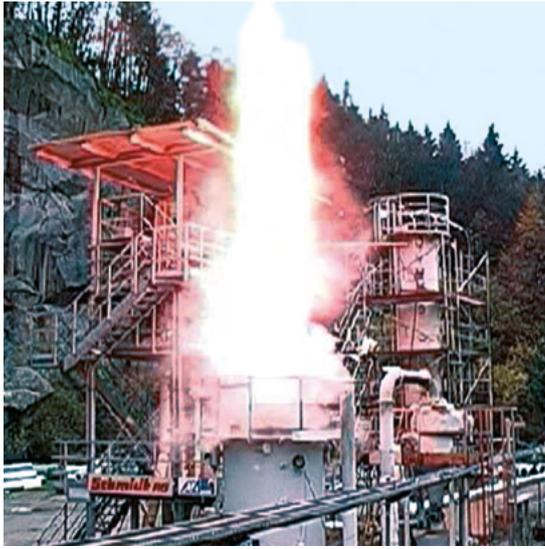
Abbildung 6: Explosionsdruckentlastung
