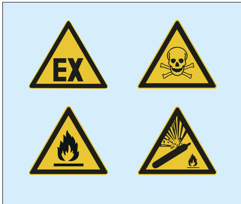
Bild 13: Hauptgefahren beim Lagern und Verwenden von Flüssiggas: Explosions-, Brand- und Vergiftungsgefahr, explodierende Gasflaschen
