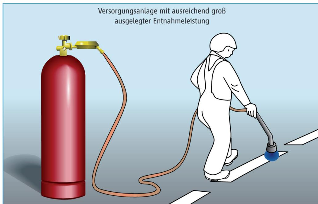
Bild 25: Maßnahme zum gefahrlosen Sicherstellen der Entnahmeleistung
