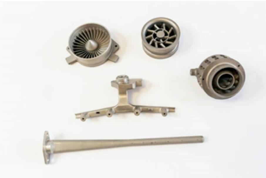
**Figura 1:** Esempi di pezzi metallici realizzati con tecnologie additive
