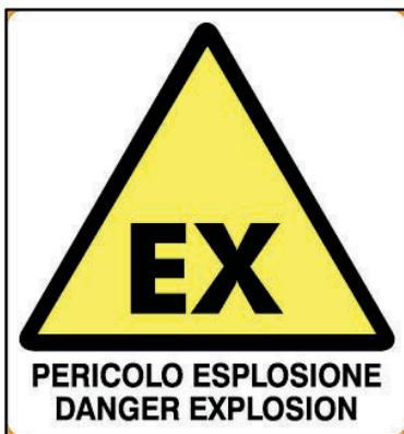
**Figura 24:** Segnale di avvertimento per indicare le aree in cui possono formarsi atmosfere esplosive (allegato LI del d.lgs. 81/2008), con scritte integrative
