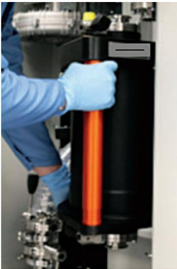
c) Rimozione/collocamento di elemento filtrante
