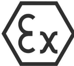
Figura 23: Esempio di marcatura ATEX
