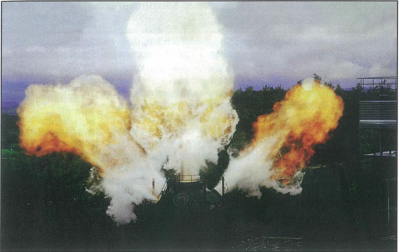
Abb. 17: Druckentlastung eines 250-m<sup>3</sup>-Behälters
