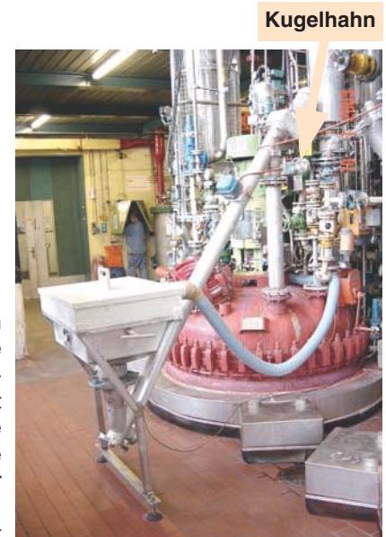
Bild 14: Befüllen eines inertisierten Reaktors mit pulverförmigen Stoffen
