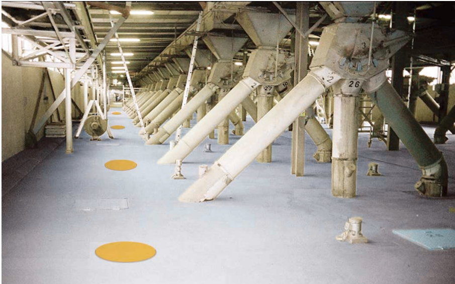
Bild 1: Beispiel für „gute“ Reinhaltung auf dem Siloboden, daher keine Zone (Markierung sichtbar)
