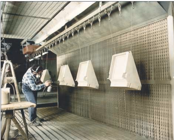
Bild 12: Farbspritzstand, der mit einer technischen Lüftung ausgestattet ist
