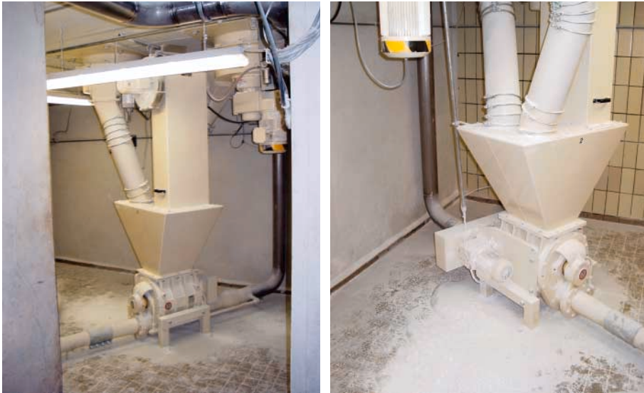
Bild 4: Produkteinspeisung in eine pneumatische Förderanlage
