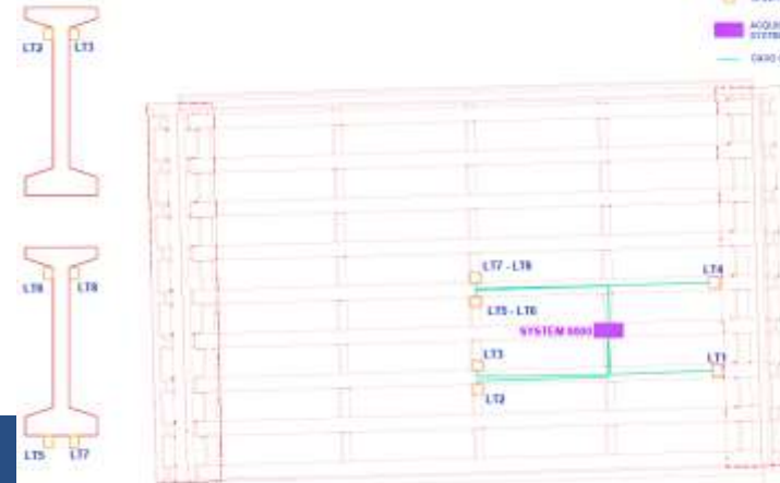
LAYOUT SENSORI LASER A TRIANGOLAZIONE
